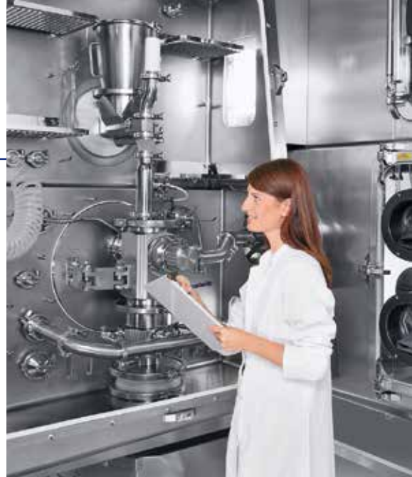
70 ZPS Isolatorintegration mit gravimetrischer Dosierschnecke PDD 25
